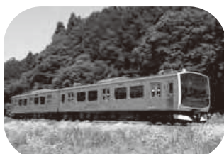
EV-E301系 蓄電池駆動電車 (ACCUM)
